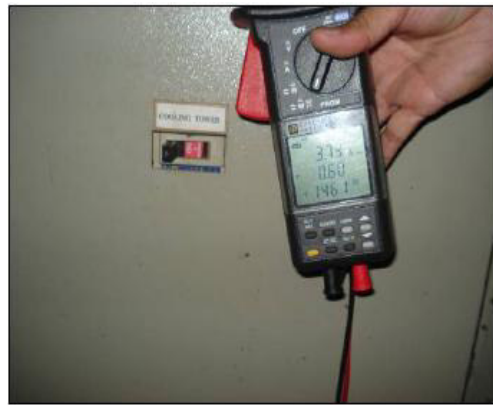
รูปแสดงหอผึ่งน้ำและค่าการตรวจวัดพลังงานของพัดลมหอผึ่งน้ำ (Cooling tower)
