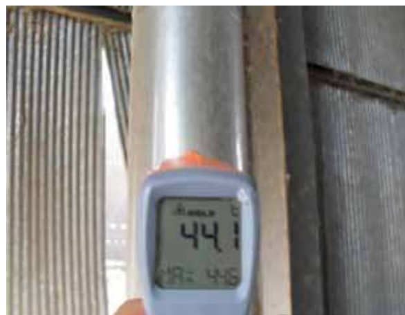
รูปแสดงระบบท่อไอน้ำ หลังดำเนินการปรับปรุงและการตรวจวัด
