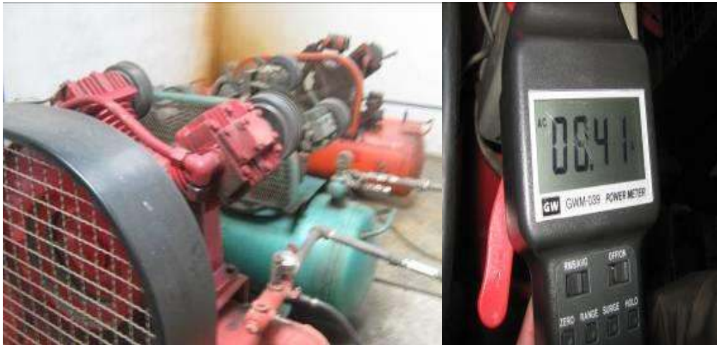
รูปเครื่องอัดอากาศ และการตรวจวัดการใช้พลังงานไฟฟ้า
