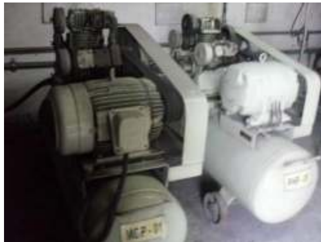
รูปเครื่องอัดอากาศที่ใช้ในกระบวนการผลิตขนาด 11 กิโลวัตต์ 2 เครื่อง
