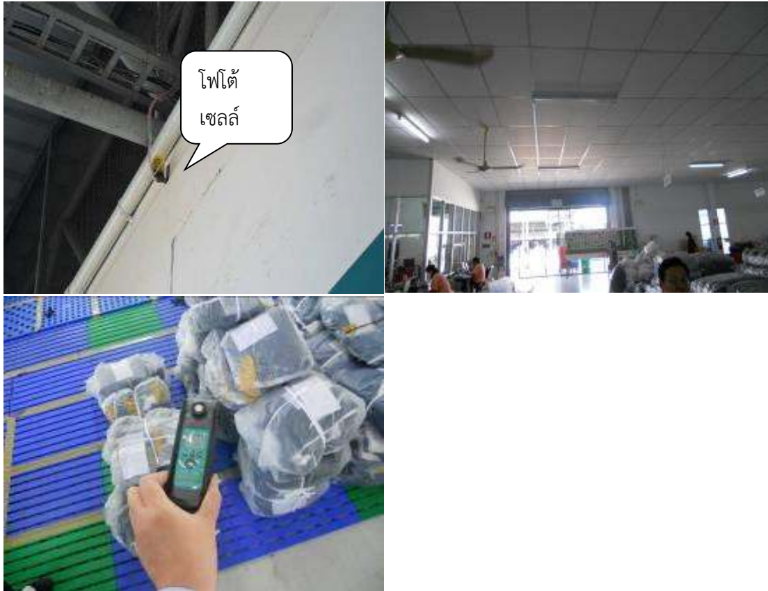
รูปแสดงการปิดหลอดที่ไม่จำเป็นและการตรวจวัดค่าความส่องสว่าง
