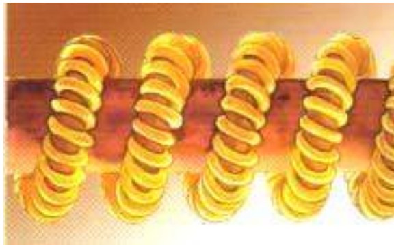
รูปที่ 1-10 ภาพขยายของไส้หลอดแบบ “Coiled-Coil” Filament
