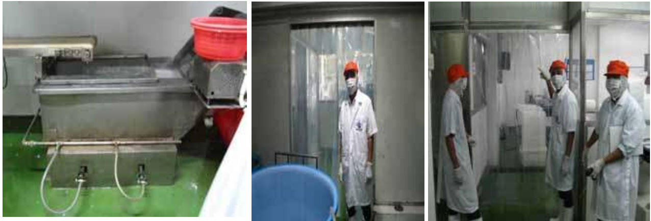
รูปแสดงการปรับปรุงหม้อต้ม - ลวกและการกันพื้นที่ ร้อน - เย็น
