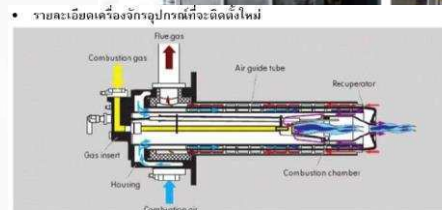
รูปที่ 4.3 ส่วนประกอบของหัวเผาแบบเซลล์ไฟฟ้ดิวเทอเรียม
